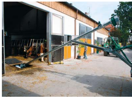
Rührgigant Z4 an einer geschlossenen Grube mit Einschwenkzylinder
