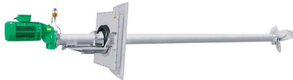
Rührgigant AMT als Schnell- oder Langsamläufer, Stirnradgetriebe (75 dB), bis 6,5m Rohrlänge, Rohr-Ø220mm in V4A, mit Drehkranz +/- 25°, hydraulische Neigungsverstellung, bis 8m unter Füllstand einsetzbar.
