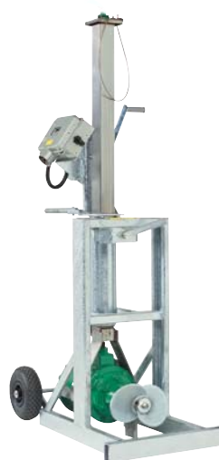
Optimix U mit schmalem Fahrwerk und Teleskopausführung
